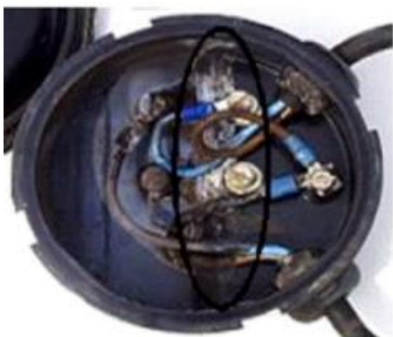
شکل (۹): خوردگی پنل‌های خورشیدی در جعبه اتصالات.
