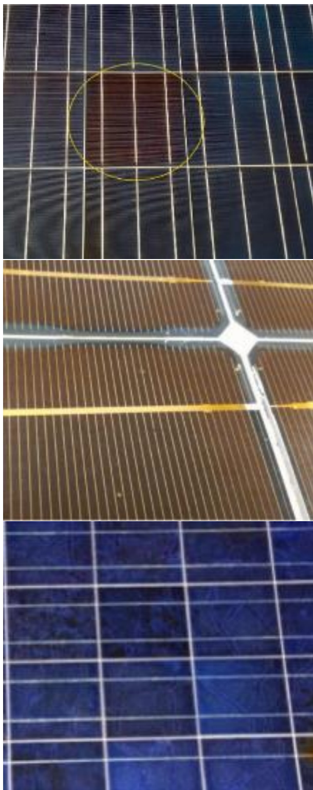
شکل (۶): اثر حلزونی روی سطح پنل های خورشیدی.
