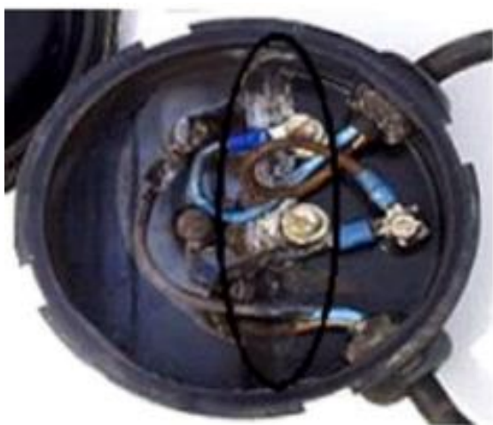
شکل (۹): خوردگی پنل‌های خورشیدی در جعبه اتصالات.
