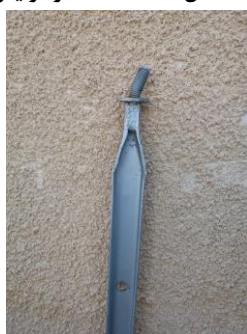
شکل ۱۵: عدم استحکام مناسب سرتیری مهره‌خور سیلیکونی استفاده شده
