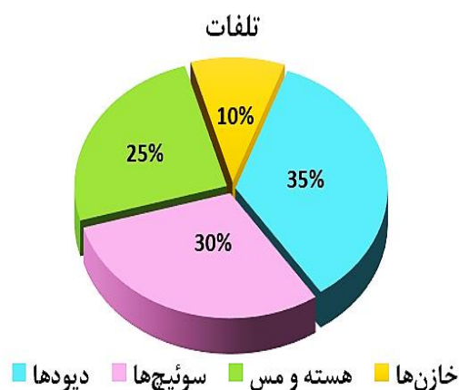
شکل (۱۰): توزیع تلفات در اجزای مدار در مبدل پیشنهادی
