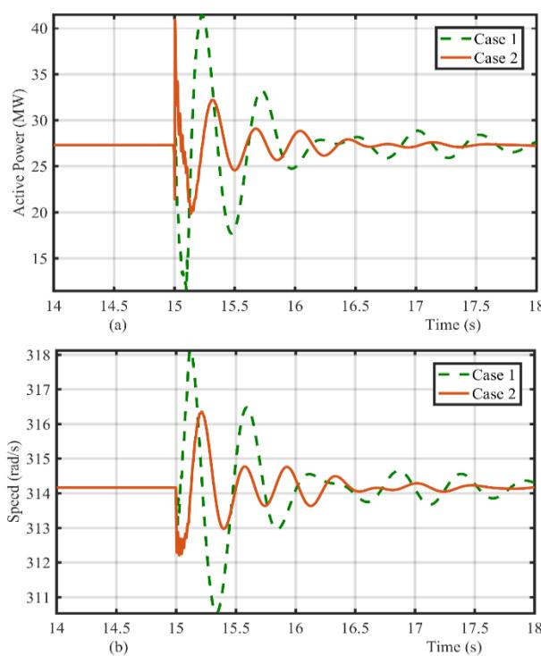
شکل (۲۰) : عملکرد مولد ۲ در دو حالت با و بدون محدودساز بین خطی،
