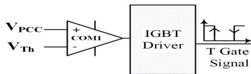
شکل (۴): سیستم کنترل محدودساز بین خطی
