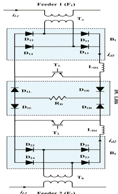
شکل (۲) : ساختار محدود ساز بین خطی همانطور که در این شکل نشان داده شده است با عبور جریان از کلیدهای  $T_1$  و  $T_2$ ، مقاومت محدود ساز در حالت باس قرار می‌گیرد و هیچ جریانی از آن عبور نمی‌کند. همچنین به علت عبور جریان مستقیم از راکتورهای  $L_{D1}$  و  $L_{D2}$ ، امپدانس ناشی از این راکتور تقریباً صفر می‌باشد. بنابراین افت ولتاژ محدود ساز بین خطی در این شرایط فرض ناچیز بودن افت ولتاژ ناشی از سوئیچینگ کلیدها و مقاومت
