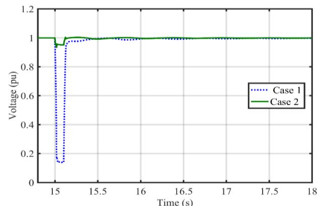
شکل (۱۳) : ولتاژ باس مشترک (BUS47) در شرایط اتصال کوتاه سه فاز به زمین در ابتدای فیدر شماره ۱ در حالت بدون / با وجود محدودساز جریان خط
