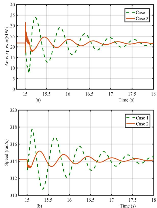
شکل (۱۸) : عملکرد مولد ۱ در دو حالت با و بدون محدودساز بین خطی،
