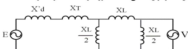
شکل (۸): مدار معادل سیستم دو باسه با خطای سه فاز در سمت خط L2
