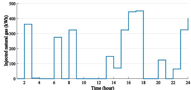
شکل ۱۱. میزان گاز توزیقی به شبکه توسط مبدل (سناریو ۵)
