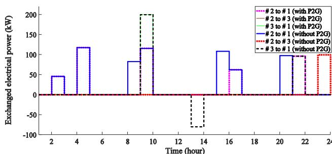
شکل ۱۵. تبادل انرژی الکتریکی بین هاب‌ها (سناریو ۵)
