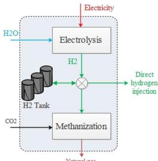
شکل ۱. کلیات سیستم مبدل برق به گاز
