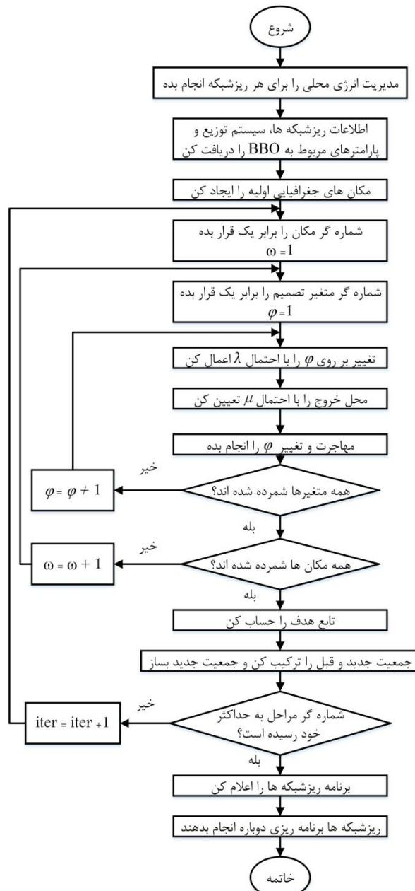
شکل (۳): فلوچارت روش مدیریت انرژی سیستم ریزشبکه چندگانه با استفاده از الگوریتم BBO
