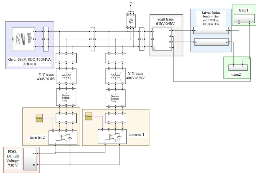
شکل (۱): نمای سیستم تغذیه قطار توسط شبکه و تولید پراکنده انعطاف پذیر اتصال یافته توسط اینورتر دوبل
