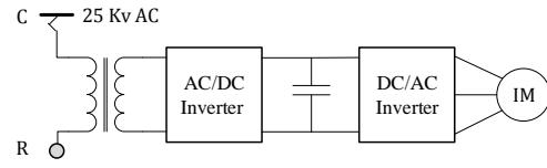
شکل (۴): شماتیک کلی مدل بار قطار
