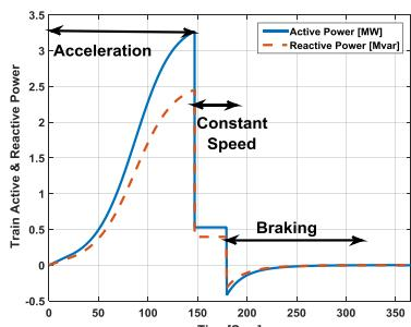
شکل (۶): نمودار توان اکتیو و راکتیو در نظر گرفته شده برای مدل بار قطار [18]
