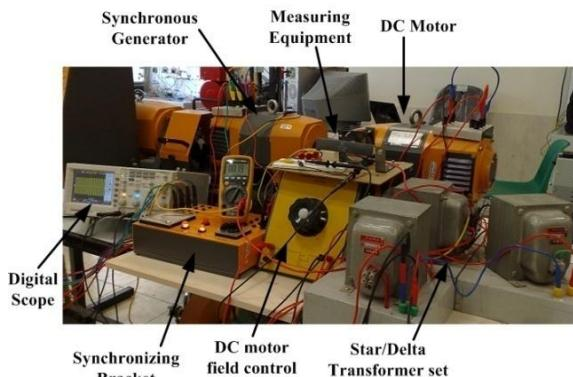
شکل (۱۷): شمای مجموعه تست در آزمایشگاه حفاظت
