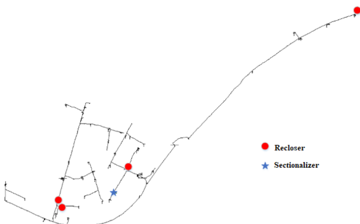
شکل ۱۳. موقعیت بهینه تجهیزات حفاظتی نظیر ریکلوزر و سکشن‌لایزر در سناریو ۳
