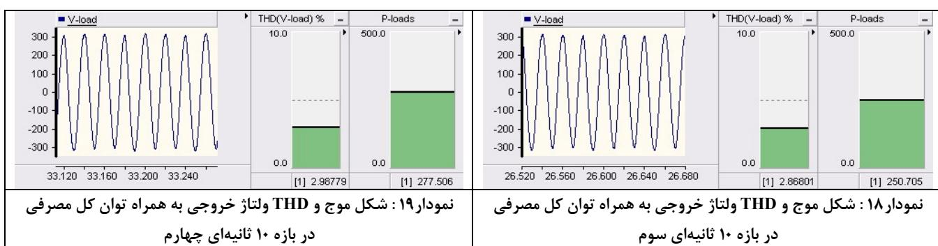
نمودار ۱۹: شکل موج و THD ولتاژ خروجی به همراه توان کل مصرفی در بازه ۱۰ ثانیه‌ای چهارم
