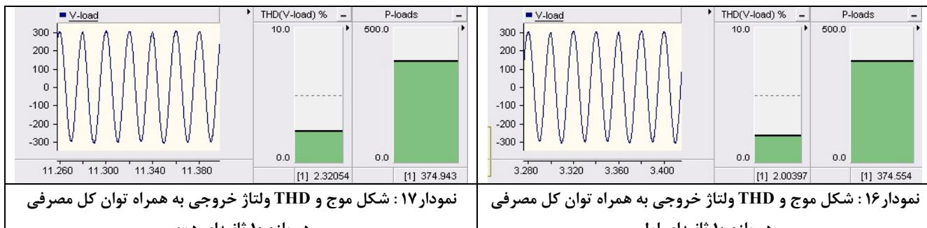
نمودار ۱۷: شکل موج و THD ولتاژ خروجی به همراه توان کل مصرفی در بازه ۱۰ ثانیه‌ای دوم
