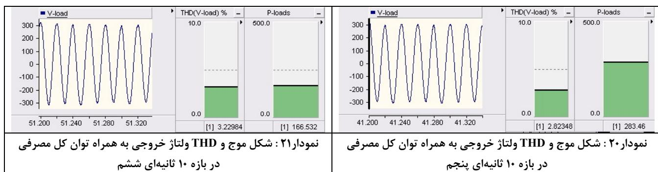
نمودار ۲۱: شکل موج و THD ولتاژ خروجی به همراه توان کل مصرفی در بازه ۱۰ ثانیه‌ای ششم
