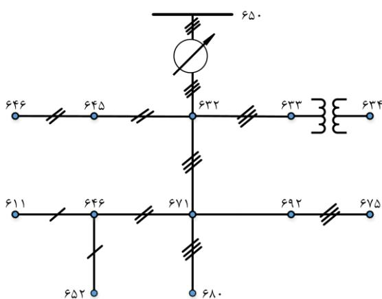
شکل (۱): سیستم تست استاندارد ۱۳ باسه IEEE
