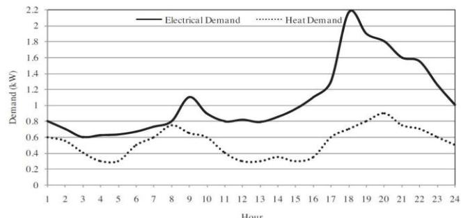
شکل ۳- بار الکتریکی و حرارتی هاب انرژی
