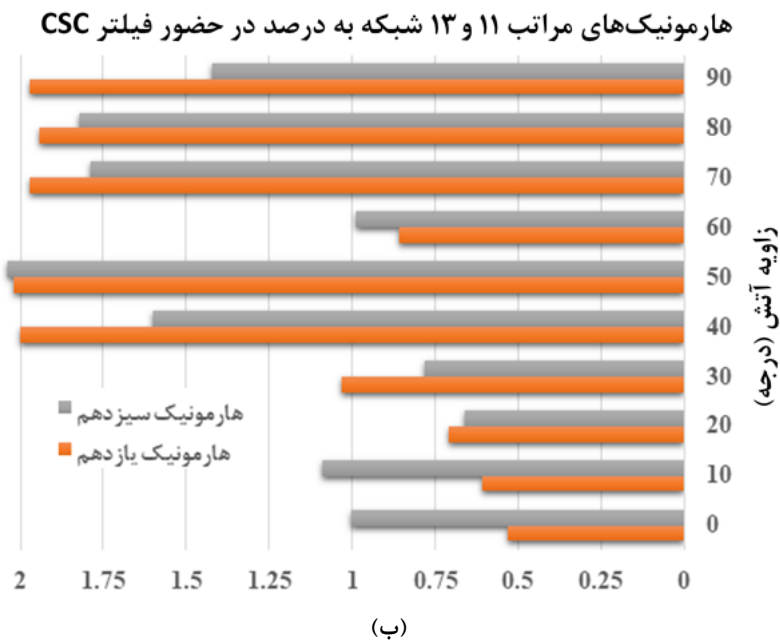
شکل ۱۶: هارمونیک‌های جریان شبکه با CSC با افزایش ۱۰۰ برابری المان‌های پس‌یو: (الف) هارمونیک‌های پنجم و هفتم، (ب) هارمونیک‌های یازدهم و سیزدهم
