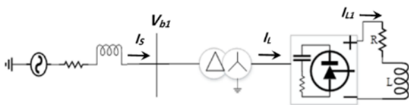
شکل ۱: ساختار شبکه توزیع با بار غیرخطی (یکسو کننده ترستوری با بار RL)
