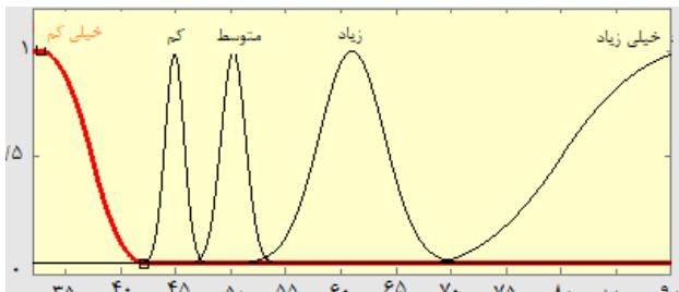
شکل ۱: توابع عضویت متغیر ورودی تفاوت مصرف
