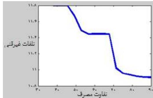
شکل ۷: نمای سطح تأثیر تفاوت مصرف بر تلفات غیر فنی انرژی با مقدار ثابت خسارت مصرف با مقدار ۱۳ میلیون کیلووات ساعت در شکل ۷، خسارت مصرف با مقدار ۱۳ میلیون کیلووات ثابت فرض شده و تأثیر تفاوت مصرف بر تلفات غیر فنی قابل رویت است. مشخص است که با افزایش میزان تفاوت مصرف تا حدود ۵۰ میلیون کیلووات ساعت، تلفات غیر فنی تا حدود ۱۱/۴ میلیون کیلووات ساعت کاهش می یابد و با فرض اعمال خسارت مصرف در حدود ثابت ۱۳
