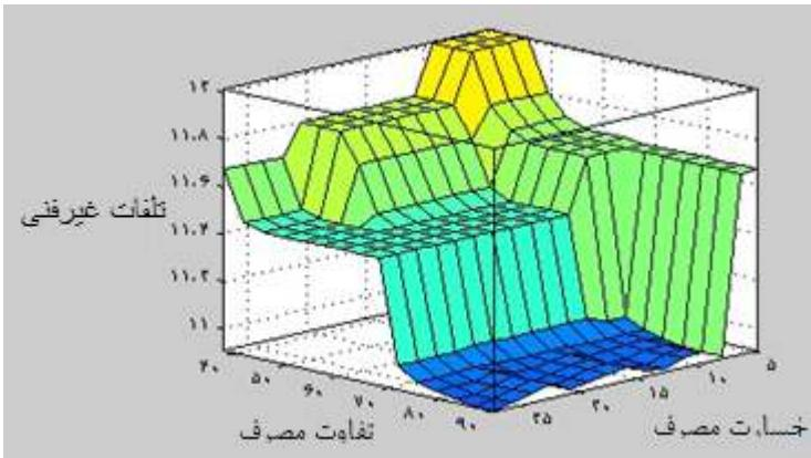
شکل ۵. رفتار متغیر میزان تلفات غیر فنی با تغییر در دو متغیر ورودی خسارت مصرف و تفاوت مصرف
