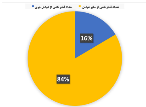
شکل ۱: تفکیک درصد تعداد قطع فیدهرها براساس عوامل جوی و غیرجوی
