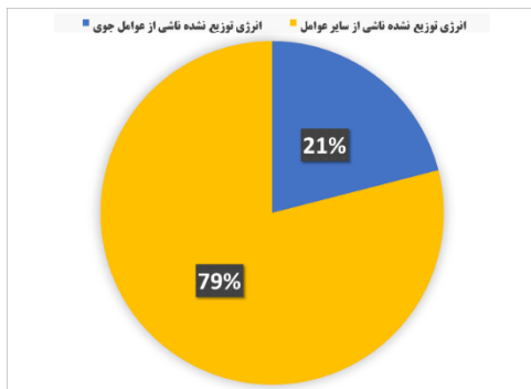
شکل ۲: تفکیک درصد انرژی توزیع نشده فیدهرها براساس عوامل جوی و غیرجوی
