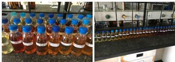
شکل (۵): نمونه روغن‌های اخذشده جهت طیف‌نگاری نوری تمامی نمونه‌ها به روش توضیح داده و پیشنهادی در این مقاله رقیق‌سازی شده و توسط دستگاه اسپکتروسکوپی، شدت و طول موج جذب نمونه‌ها اندازه‌گیری شده‌اند (نتایج این آزمایش‌ها در بخش ضمایم جدول (ب) آورده شده است)، در مرحله بعد با توجه به مقادیر بدست‌آمده از نتایج HPLC و شدت و طول موج جذب، یک الگوریتم منطق‌فازی طراحی و ارائه شده است که استفاده از این روش را برای کاربر ساده‌تر می‌کند. شکل ۶، نتایج اسپکتروسکوپی چند نمونه را نشان می‌دهد.
