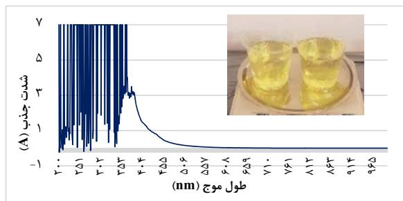
شکل (۲): رنگ روغن تازه کارکرده ترانسفورماتور و طیف نوری آن
