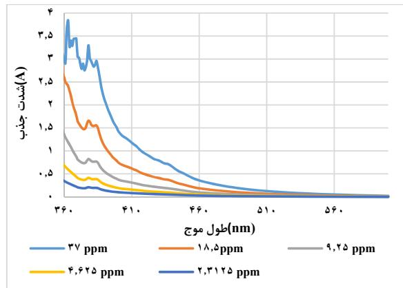
شکل (۴): طیف نوری نمونه ۳۷ ppm و نمونه‌های ساخته شده
