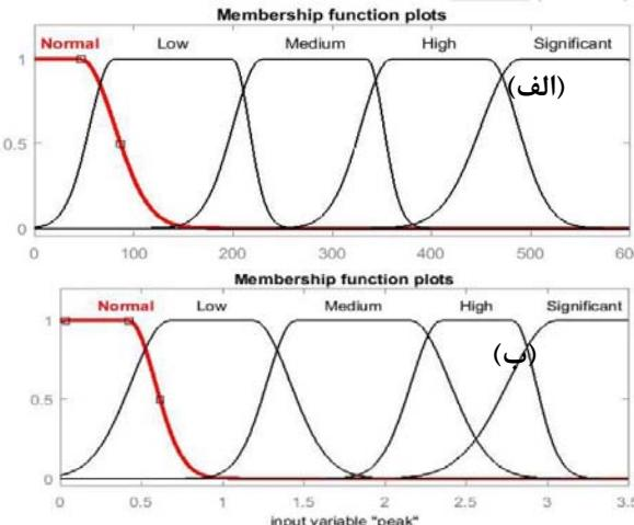
شکل (۷): توابع عضویت ورودی‌های منطق فازی، الف- توابع عضویت ورودی پهنای باند، ب- توابع عضویت ورودی شدت جذب روش مرکز ثقل، که به طور گسترده در مدل‌های فازی مورد استفاده قرار می‌گیرد برای فازی زدایی خروجی الگوریتم مورد استفاده قرار گرفت که با فرض  $Z_0$  به عنوان خروجی، مقدار آن بر اساس رابطه شماره (۷) محاسبه گردید:
