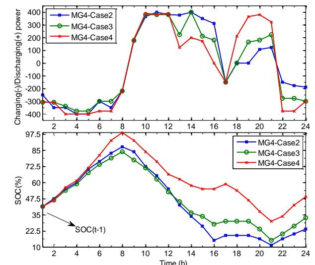
شکل (۱۵): میزان SOC و توان شارژ و دشارژ BESS‌ها در MG<sub>4</sub>
