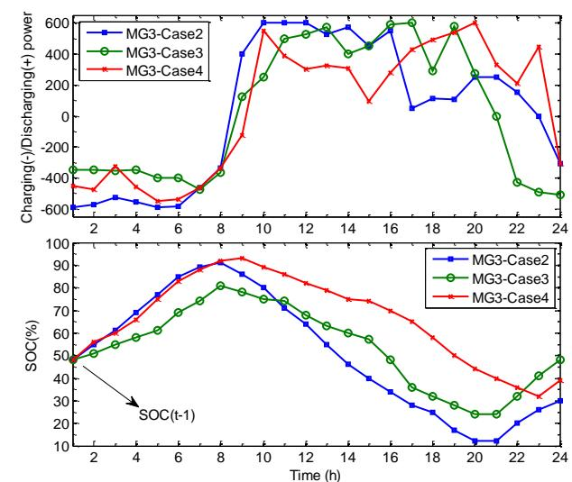
شکل (۱۴): میزان SOC و توان شارژ و دشارژ BESS‌ها در MG<sub>3</sub>
